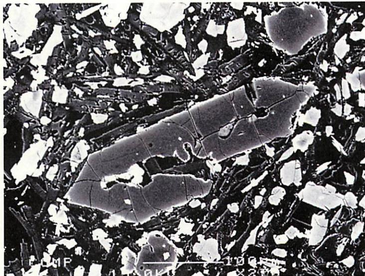
図 1 火山岩 A で観察されるカンラン石の微斑晶 (反射電子像).
